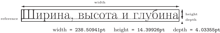
Рис. 6.1. Определение ширины (width), высоты (height) и глубины (depth)
