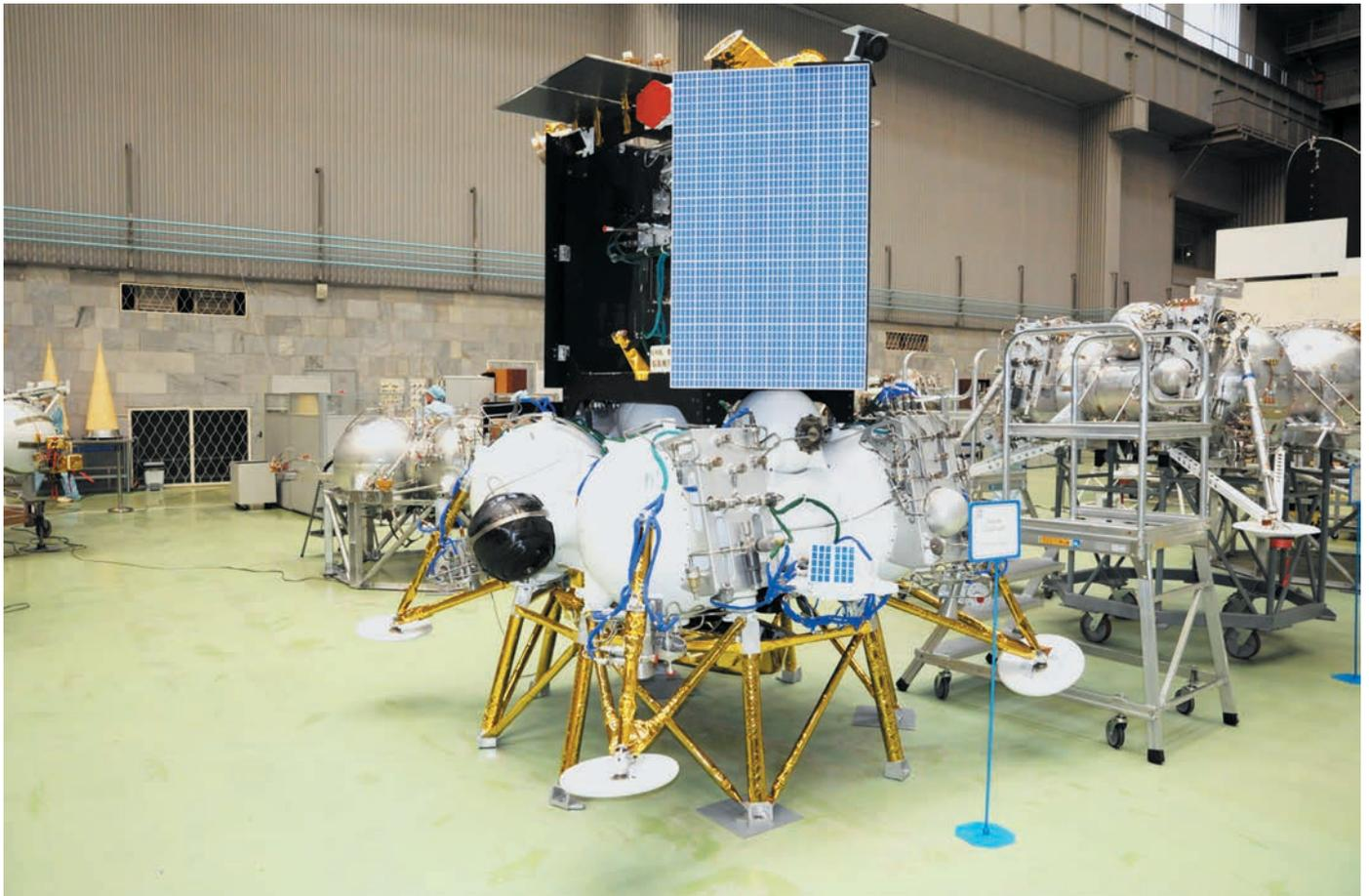
рисунок 4. Модель КА «ЛУНА-25», на которой проводятся конструкторские испытания
